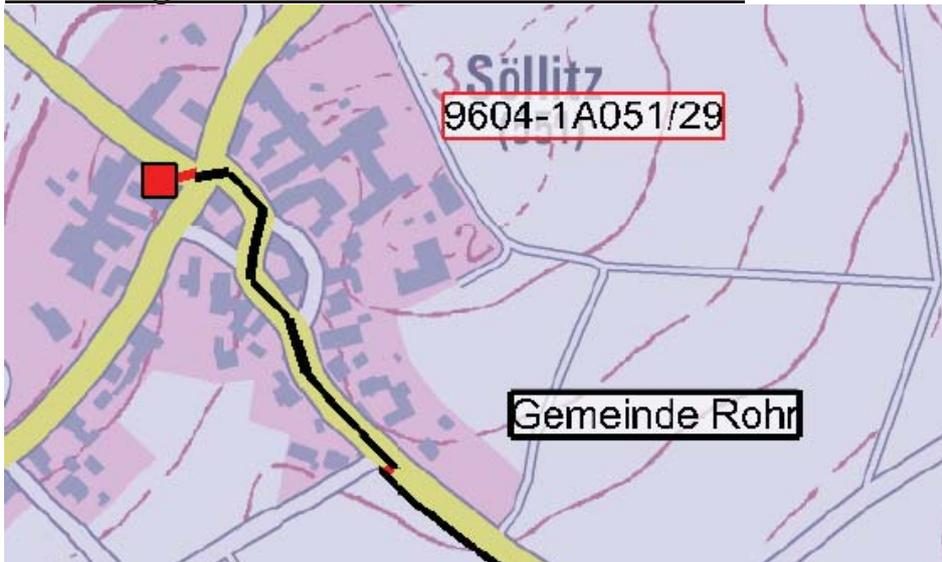
wird unsererseits ein Outdoor-DSLAM MFG mit modernster VDSL2-Technik aufgebaut, sowie per Glasfaser versorgt und mittels Kollokation an den bestehenden KVz angebunden.
